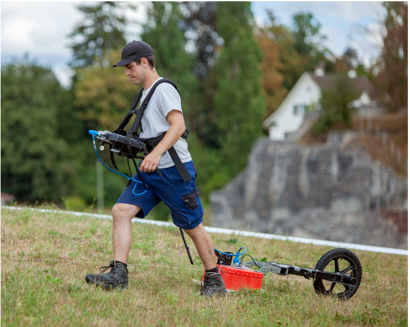
Abschreiten der Messfläche mit der Radarantenne. Mit einer Antenne (rotes Gerät) wird auf einer Breite von 50 cm gemessen. Foto Susanne Schenker
