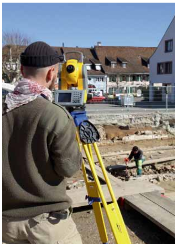
Abb. 7: Vermessung im Feld mittels Tachymeter. Die Ergebnisse der Messungen werden in für das Geografische Informationssystem lesbare Daten ausgegeben. Grabung Kaiseraugst-«Löwen», 2010.001.
