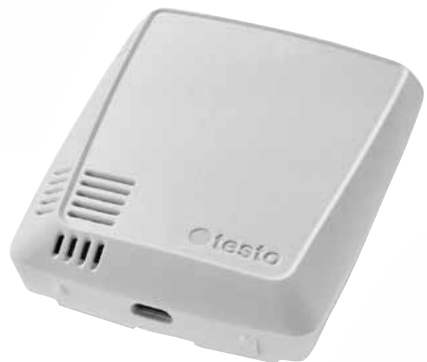
Abb. 5: Sammlungs-zentrum Augusta Raurica. Datenlogger des Typs testo 160 TH. 52 Datenlogger sind im Depot des Sammlungs-zentrums installiert, um rund um die Uhr sowohl die Temperatur als auch die Feuchtigkeit zu messen und aufzuzeichnen.
