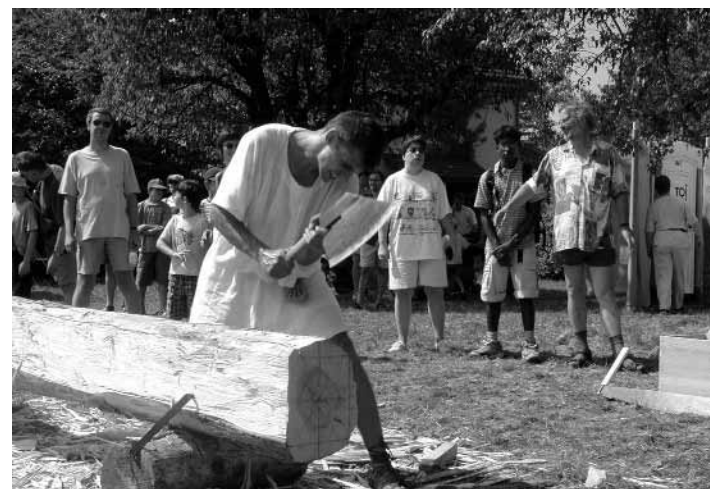
Stunden Handarbeit für einen geraden Balken: «Zimmermann» David Kellenberger demonstriert am Römerfest mit der Schlichttaxt eine Technik, die von der Antike bis zum Beginn der Industrialisierung gang und gäbe war und heute durch Maschinen geleistet wird. (Foto Alex R. Furger)
