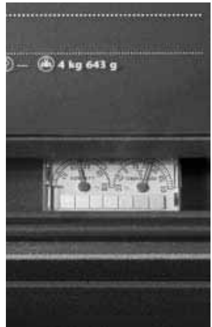
Thermohygrometer in Kleinformat im Inneren der Vitrinen messen die Temperatur und die Luftfeuchtigkeit. (Foto Ursi Schild)
