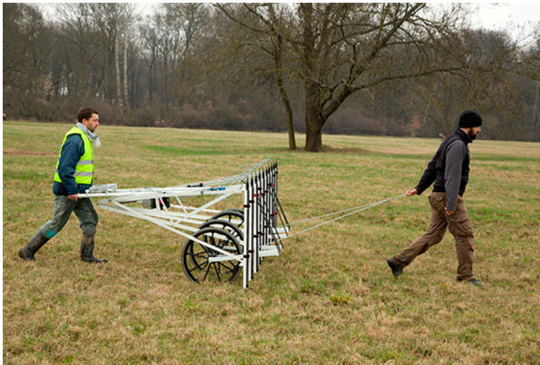
Augusta Raurica (Schweiz) Mit einem solchen Magnetometer werden in der Römerstadt verborgene Strukturen gesucht. © Universität Brno (Tschechien)
